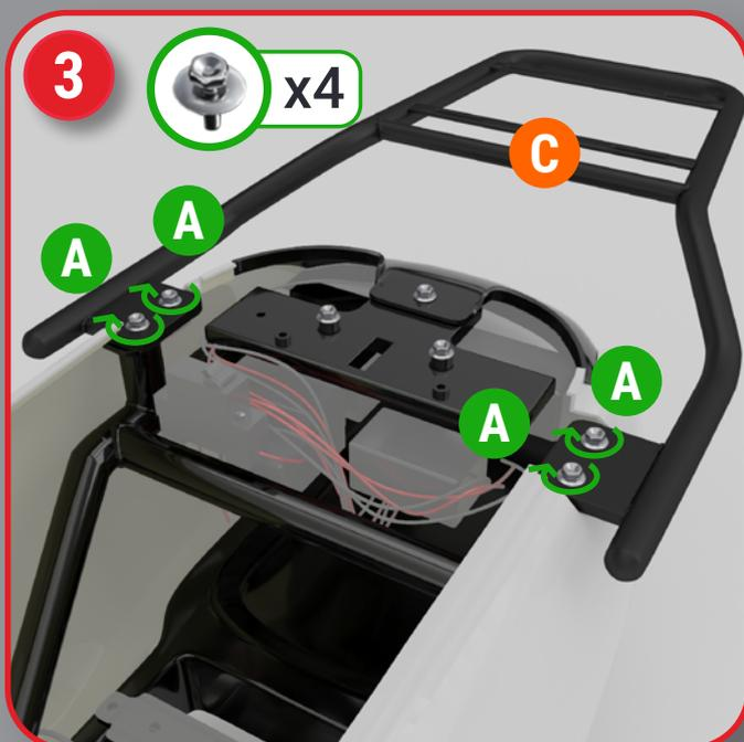
**DE** - Setzen Sie das Topcase (F) auf den Topcaserahmen (C) und setzen Sie die Schrauben ein (E - 4x Schrauben, 4x Schnellscheibe) durch die Löcher
