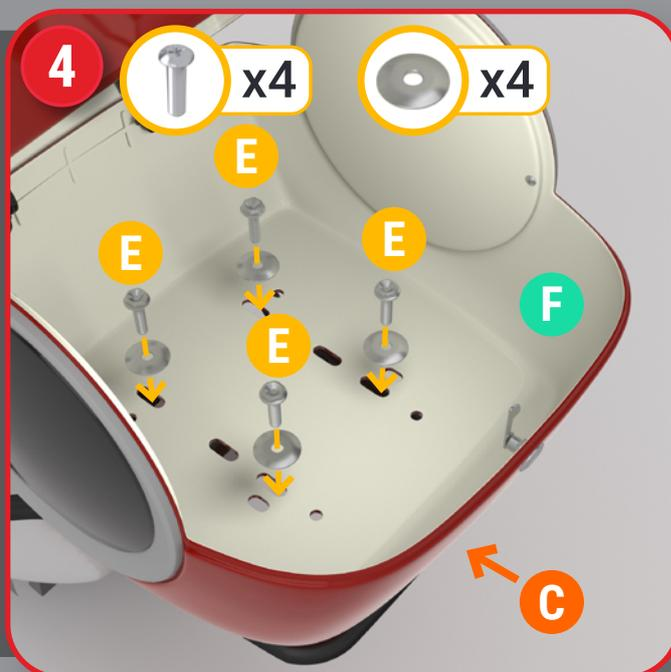
**DE** - Topcase (F) ist jetzt auf einem Topcaserahmen (C) montiert
