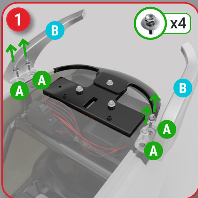
**DE** - Lösen (A - 4x Schrauben) und entfernen Sie die Metallgriffe (B)
