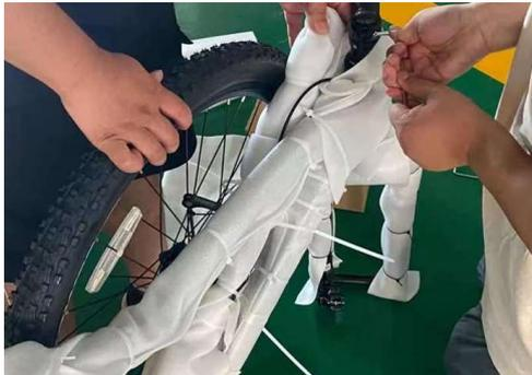
Im Anschluss nehmen Sie den Vorderradschutz und den Vorderradgabelschutzbügel ab.
