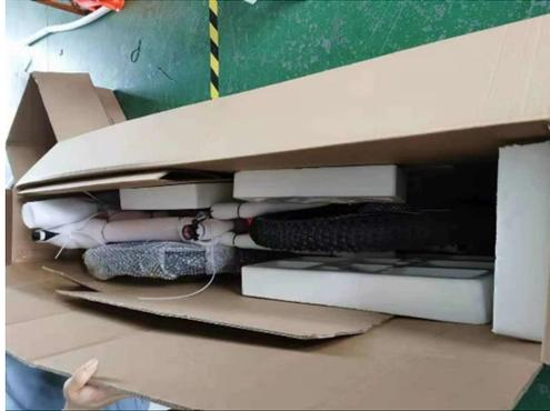
Durchtrennen Sie die Kabelbinder, die das Vorderrad während des Transports sichern →
