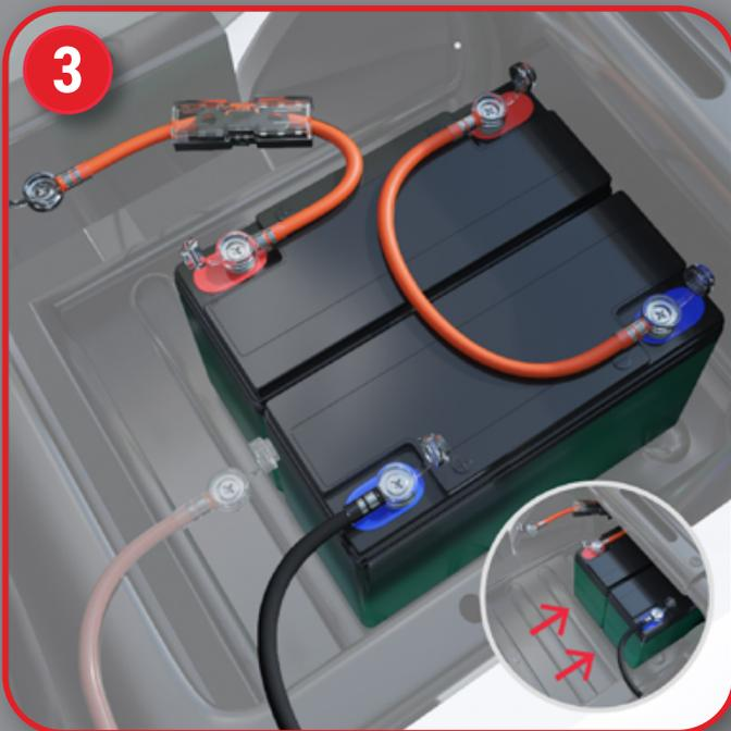
**DE** 4 - Legen Sie die restlichen Batterien ein und schließen Sie die Drähte an
