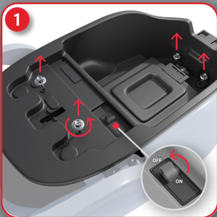
**DE** 1 - Schalten Sie die Batterie aus, schrauben Sie den Deckelschalter ab und entfernen Sie ihn
