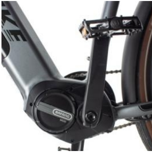
Das linke Pedal zieht gegen den Uhrzeigersinn
