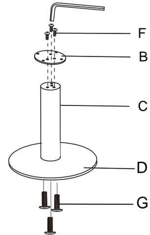
3. Befestigen Sie die Tischplatte (A) mit 4 Schrauben M6x16mm am Tischplattenhalter (B).
